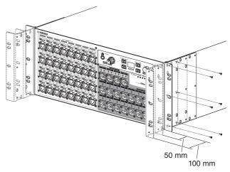
De même, vous pouvez installer des supports de montage en rack sur la surface du panneau arrière.
